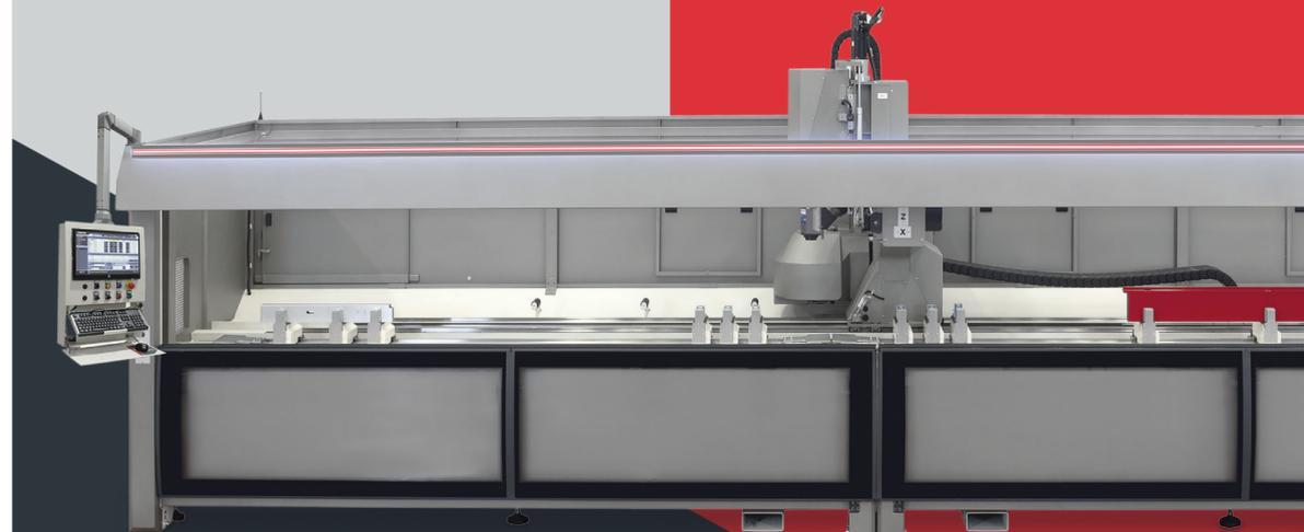
I fermi di battuta (destra, centrale, sinistra) a scomparsa permettono di posizionare profili con lunghezze complementari. Si possono lavorare fino a tre profili diversi, anche con sezioni e cicli differenti.
